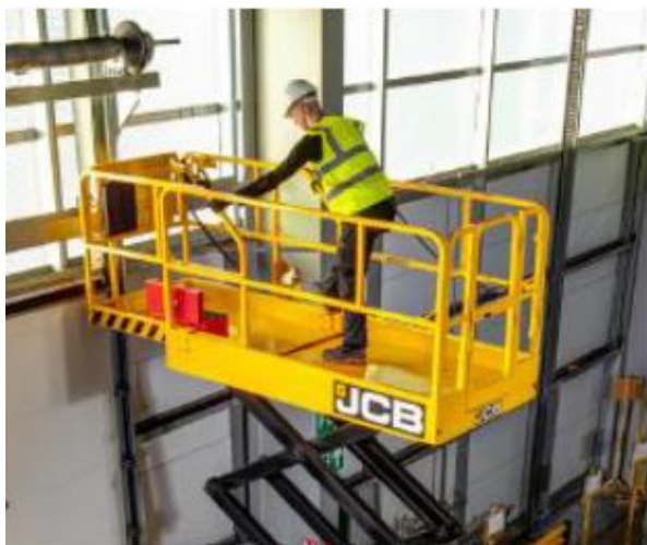
Extensão da plataforma - A plataforma desliza sobre roletes para facilitar a extensão e recolha Sistema de retenção com cavilha acionada por mola e desbloqueio através de pedal
