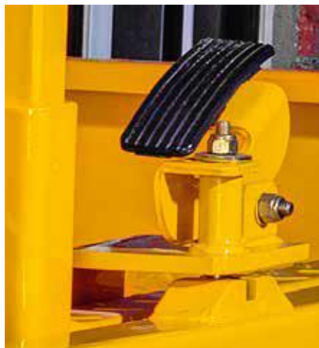
Extensão da plataforma - A plataforma desliza sobre roletes para facilitar a extensão e recolha Sistema de retenção com cavilha acionada por mola e desbloqueio através de pedal
