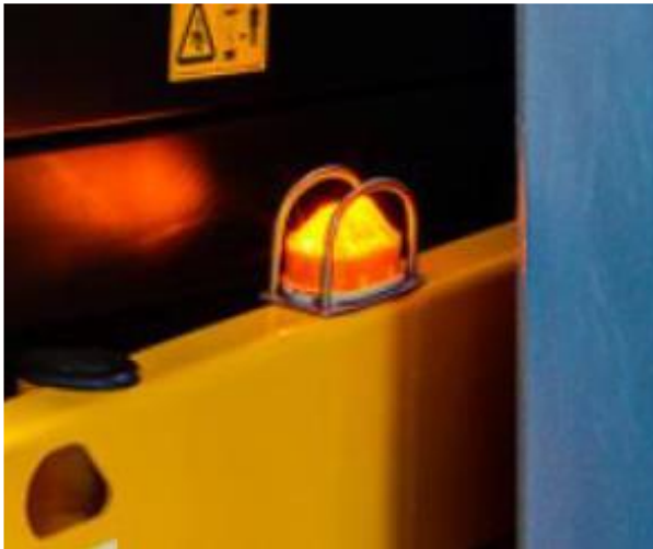
Proteção dos componentes expostos.
