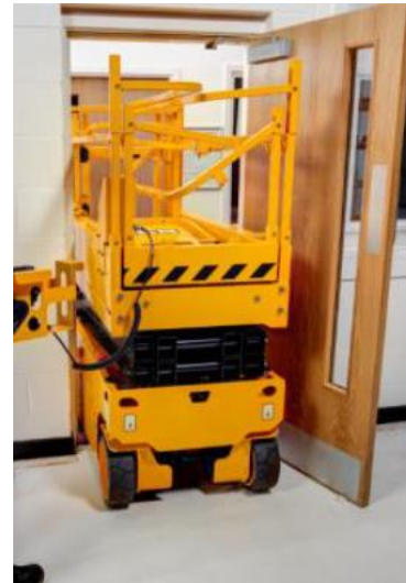
Grades rebatíveis para acesso a espaços confinados
