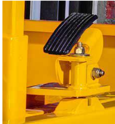
Extensão da plataforma - A plataforma desliza sobre roletes para facilitar a extensão e recolha Sistema de retenção com cavilha acionada por mola e desbloqueio através de pedal
