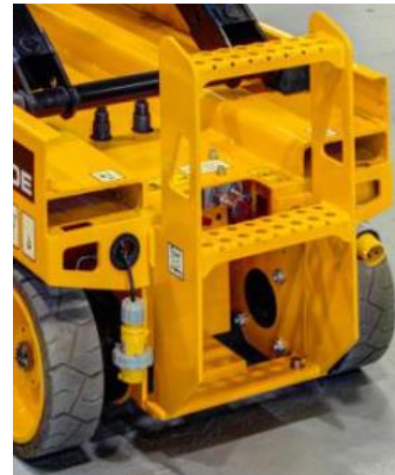
Escada robusta. Protege os comandos de emergência e as rodas
