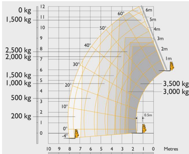
Estabilizadores recolhidos e máquina nivelada
